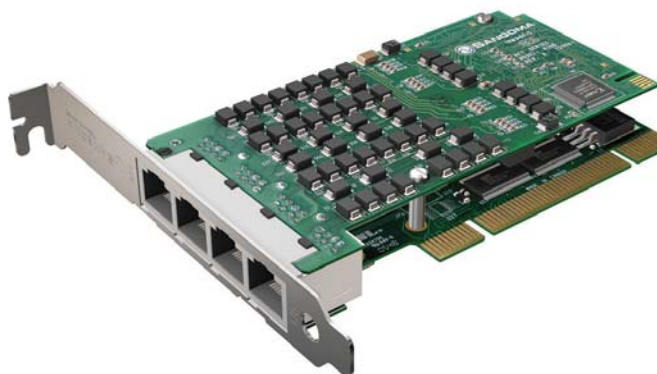
La tarjeta A108 T1/E1/J1 de 8 puertos con interfaz PCI.
